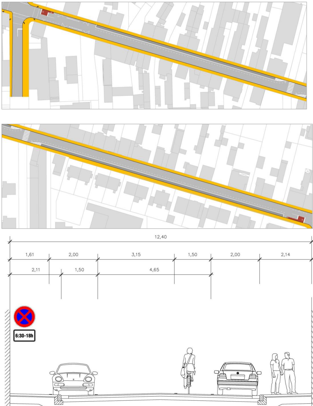
Abbildung 60: Alternierende Schutzstreifen mit beidseitigem Parken in den Abendstunden im Zuge der Offenbacher Straße im Abschnitt Herzogstraße/ Am Erlenbach – Am Trieb
